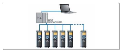
Fig. 8.8 Fieldbus wiring
